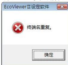
※5 计算机链接站号已重复的情况，会显示如下提示信息。点击点击[OK]按钮，请修改站号。
