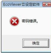
※2 在 EcoWebServer II 的 IP 地址不符，LAN 电缆的未连接或是 EcoWebServer II 的电源未连接时会显示下列信息。单击[确认]按钮后请确认 EcoWebServer II 的 IP 地址，LAN 电缆的连接以及 EcoWebServer II 的电源是否连接。
