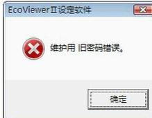
※3 新密码和新密码（确认）不符时，会显示以下信息。请单击[确定]按钮，并确认密码。
