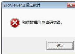
※5 在 EcoWebServer II 的 IP 地址不符，LAN 电缆的未连接，或是 EcoWebServer II 的电源未连接时会显示下列信息。单击[确认]按钮后请确认 EcoWebServer II 的 IP 地址，LAN 电缆的连接，以及 EcoWebServer II 的电源是否连接。
