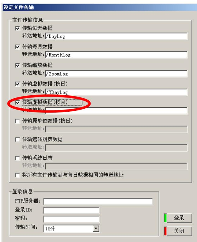
(14) 在[转送地址]栏内，键盘输入转送地址（FTP 服务器内的路径名）。
