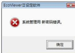
※5 在 EcoWebServer II 的 IP 地址不符，LAN 电缆的未连接，或是 EcoWebServer II 的电源未连接时会显示下列信息。单击[确认]按钮后请确认 EcoWebServer II 的 IP 地址，LAN 电缆的连接，以及 EcoWebServer II 的电源是否连接。
