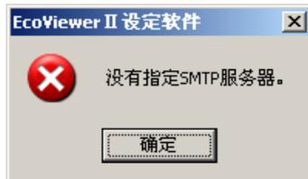
※3 在 MTP 服务器中没有输入 IP 地址，IP 地址不正确时，显示如下提示信息。请点击[OK]按钮，修改 IP 地址。但是，通知完全没有被设定时，不能被显示。
