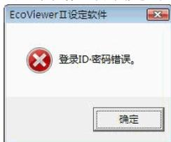
在 EcoWebServer II 的 IP 地址不符, LAN 电缆的未连接或是 EcoWebServer II 的电源未连接时会显示下列信息。单击[确定]按钮后, 请确认 EcoWebServer II 的 IP 地址, LAN 电缆的连接, 以及 EcoWebServer II 的电源是否连接。
