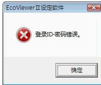
※2 在 EcoWebServer II 的 IP 地址不符，LAN 电缆的未连接或是 EcoWebServer II 的电源未连接时会显示下列信息。单击[确认]按钮后请确认 EcoWebServer II 的 IP 地址，LAN 电缆的连接以及 EcoWebServer II 的电源是否连接。
