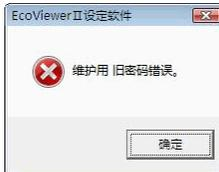
※4 在 EcoWebServer II 的 IP 地址不符，LAN 电缆的未连接，或是 EcoWebServer II 的电源未连接时会显示下列信息。单击[确定]按钮后请确认 EcoWebServer II 的 IP 地址，LAN 电缆的连接，以及 EcoWebServer II 的电源是否连接。
