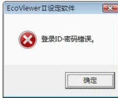
在 EcoWebServer II 的 IP 地址不符，LAN 电缆的未连接或是 EcoWebServer II 的电源未连接时会显示下列信息。
