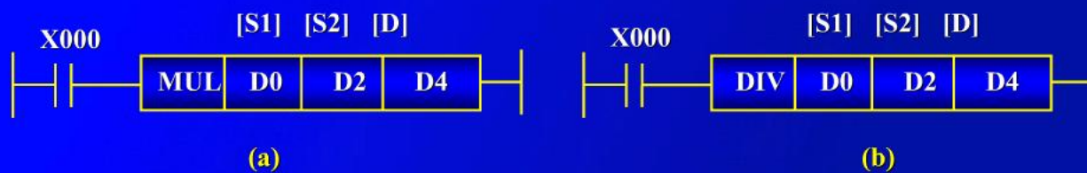
图2-35 MUL、DIV指令的使用 (a)MUL乘法指令 (b)DIV除法指令
