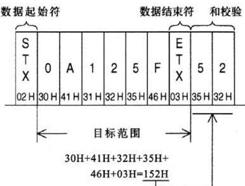
包括数据结束符并排除了数据起始符（只是数据起始符的第一个字节）的总和值将被计算出来。然后，低位1字节被转换成 ASCII 码，并且发送或接收。被转换成 ASCII 码的数据将以从高位数字到低位数字的顺序放置。
