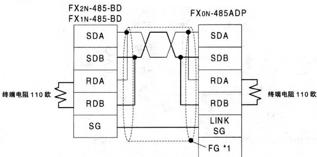
\*1 连接端子 FG 到可编程控制器主体的每一个端子，用 100 欧或更小的电阻接地。
