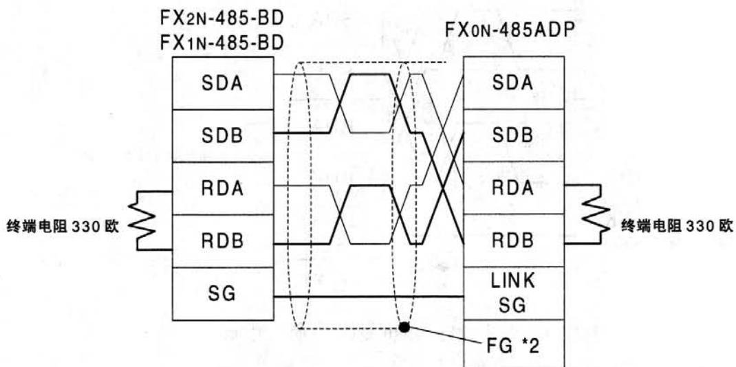
\*2 连接端子 FG 到可编程控制器主体的每一个端子，用 100 欧或更小的电阻接地。
