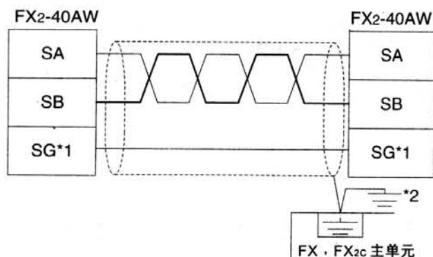
\*1 FX<sub>2</sub>-40AW 的 SG 端子连接 FX 或 FX<sub>2</sub>c 主单元的 SG 端子。
